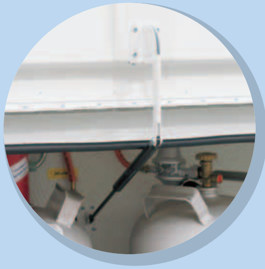
• Adora • Adiva • Classica Aerodynamisch, leicht zugänglich der Flaschenkasten mit Federaufstellung
