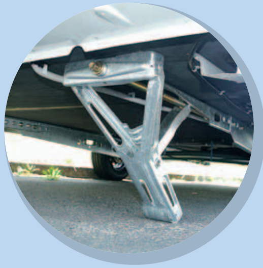
• Adora • Adiva • Classica Standfestigkeit durch Schwerlaststützen
