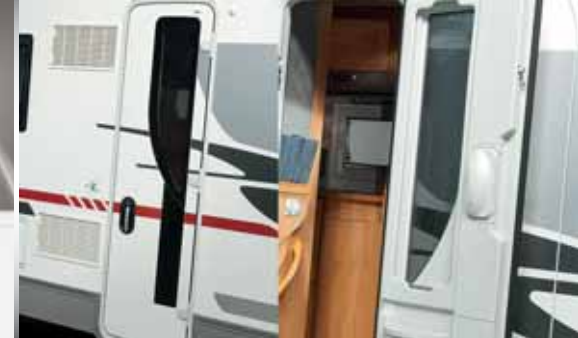
Neue Eingangstür mit Fliegengitter und Abfallbehälter
